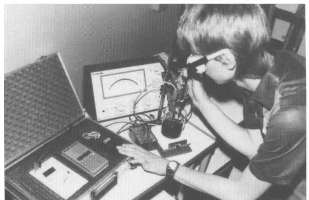
Selbständiges Dosieren kleinster Flüssigkeitsmengen mit dem Mikrodispenser; Abzurufen des pH-Wertes über den sprechenden Meßkoffer
